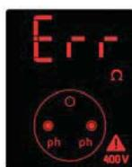
Un branchement entre les phases sous 400 V
