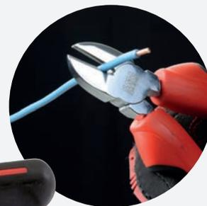
Pince polyvalente. Branches avec gaines bi-matière. Tête effilée. Forgée en acier au chrome vanadium. Performance accrue grâce au procédé de trempe haute fréquence. Pour fil acier et fil cuivre (coupe nette). C : capacité de coupe pour fil acier 160kg/mm<sup>2</sup>.
