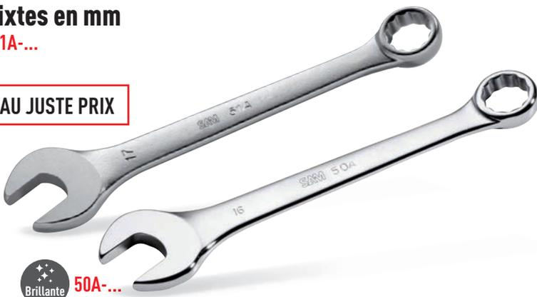
Alliance de 2 têtes de même ouverture, permettant avec la tête fourche une approche rapide de serrage et un blocage puissant avec la tête polygonale, dont le cou dage à 15° assure une manoeuvre aisée en surface plane. Forme adoucie pour le confort de la main.
