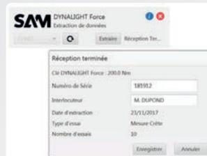
**TRAÇABILITÉ DES SERRAGES GRÂCE AU LOGICIEL SAM-DYNALIGHT Force** permettant la conversion des données enregistrées sur la clé au format Excel. Affichage des valeurs mesurées : valeur de serrage, de force et de rendement.
