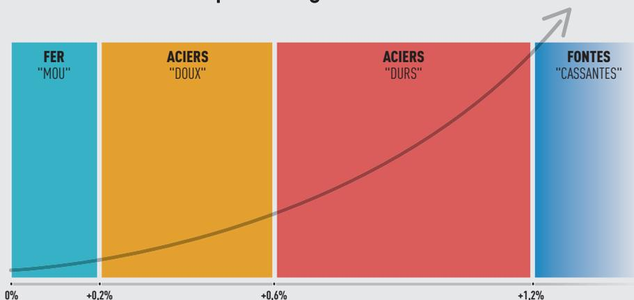
Le carbone durcit le fer, augmente sa résistance à la traction et diminue son élasticité.
