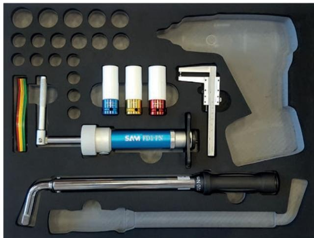
Composition idéale pour la pose et la dépose des roues VL. Ce kit vous permettra en plus de contrôler l'épaisseur des disques de frein et des plaquettes pour garantir le bon état du système de freinage. La mousse est prévue avec des emplacements spécifiques pour tous vos outils « spécial roue » déjà en votre possession comme clé à chocs pneumatique ou électrique, douilles à chocs ou classiques, clé monocouple supplémentaire à 140 Nm, etc. (non compris dans la composition).
