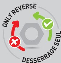
Les clés ORV disposent d'un dispositif de desserrage spécialement développé par PTS rendant la fonction de serrage impossible pour l'utilisateur. Ceci permet d'éviter les opérations de serrage non maîtrisées tout en garantissant la fonction principale de desserrage : ORV pour Only Reverse.
