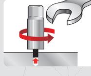
2- Dévissage de l'ensemble avec une clé de 27 mm ou un carré standard 1/2".
