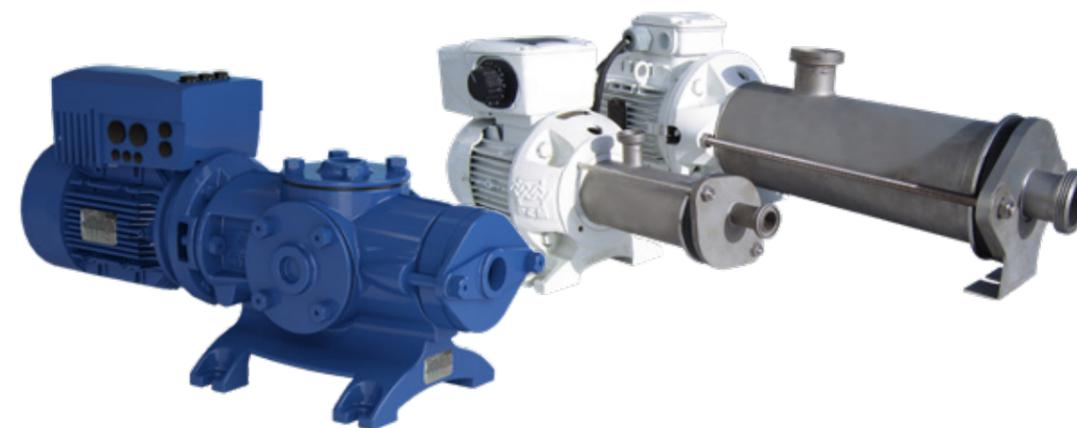
Basée sur la technologie Moineau™, la pompe à cavités progressives PCM EcoMoineau™ à stator flottant est idéale pour les encombrements réduits. Utilisant un stator flottant sans armature, cette pompe ne nécessite pas de bielle telle qu'utilisée par les pompes à vis excentrée classiques. La flexibilité du stator permet au rotor de tourner de manière excentrée, le rotor étant directement lié au moteur. Le corps de la pompe est ainsi plus court.
