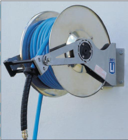
Enrouleur-dérouleur **automatique** en acier inoxydable **avec ou sans support mural orientable**. Le rappel du tuyau se fait par l'action d'un ressort de grande qualité.
